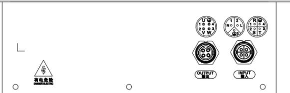
工业风扇一体机的输入和输出与一体机采用航空头对接连接,用户需要将输入、输出线接到机器配套的航空头内(配套航空头由正弦提供,接线方式为螺丝压接),线序对照机器上的丝印(如上图)。
